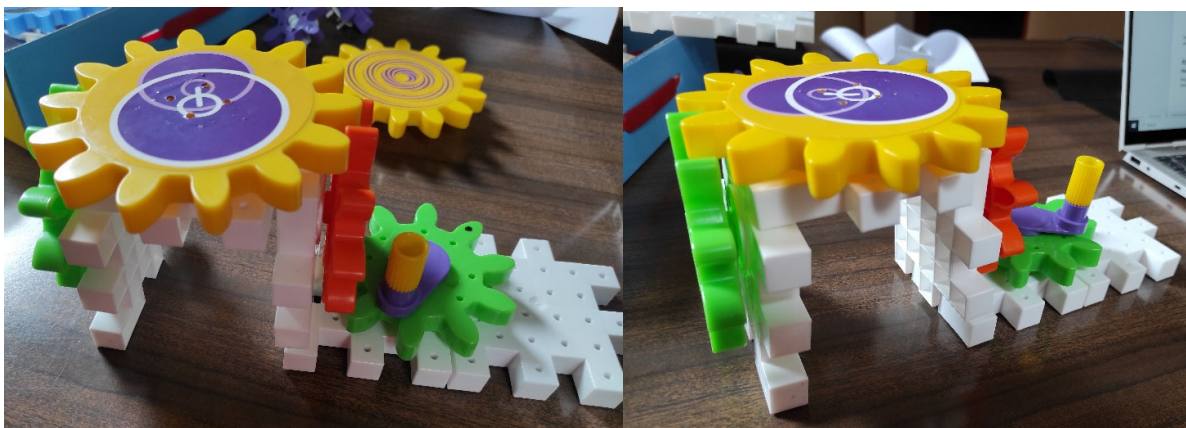
Figura 9. Cambio de plano del movimiento: la rueda conductora está horizontal y transfiere el movimiento a una rueda conducida vertical (naranja), esta, a otra horizontal (amarilla) y esta, a su vez, a otra vertical (verde).
