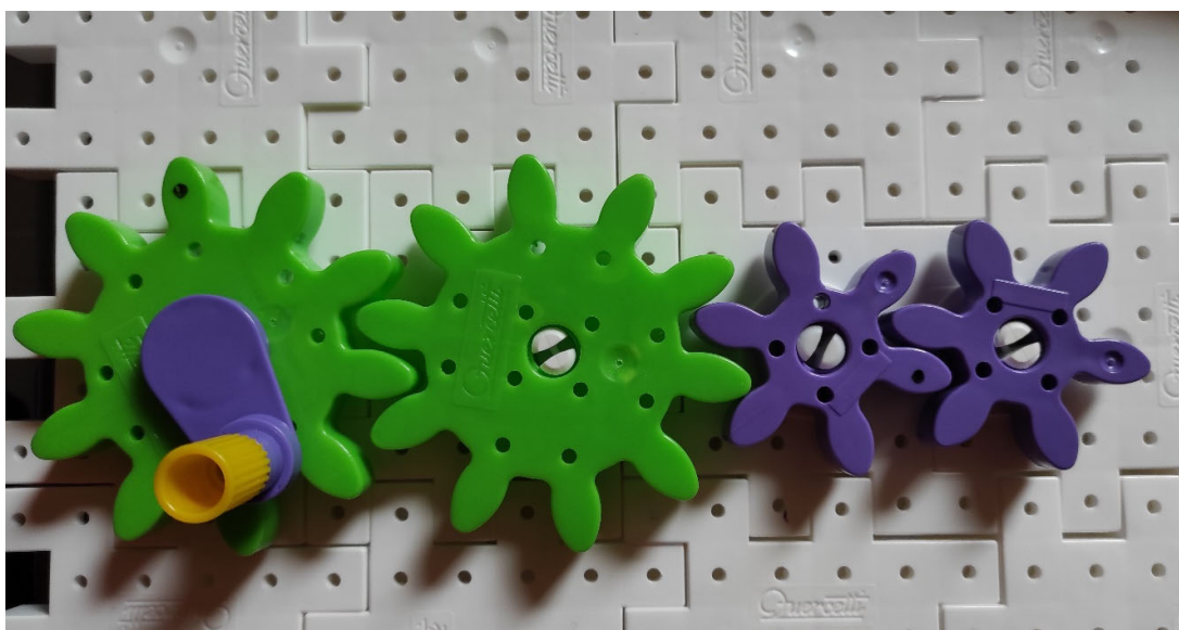
Figura 7- Transferencia de movimiento con amplificación de velocidad, a través de varias ruedas dentadas.
