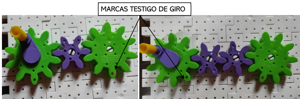
Figura 8. Comprobando que lo importante es la rueda conductora y la conducida final para la velocidad de la última rueda conducida. Las marcas testigo son importantes para comprobar que, como la rueda conductora y la final conducida son iguales, la velocidad es idéntica.
